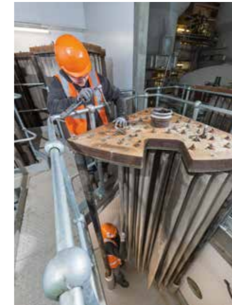
Quick, easy and secure mounting of the filter elements onto the filter segments. Montage rapide, facile et sûr des éléments filtrants sur les segments de filtre. Montaje rápido, fácil y seguro de los elementos filtrantes en los segmentos del filtro.
