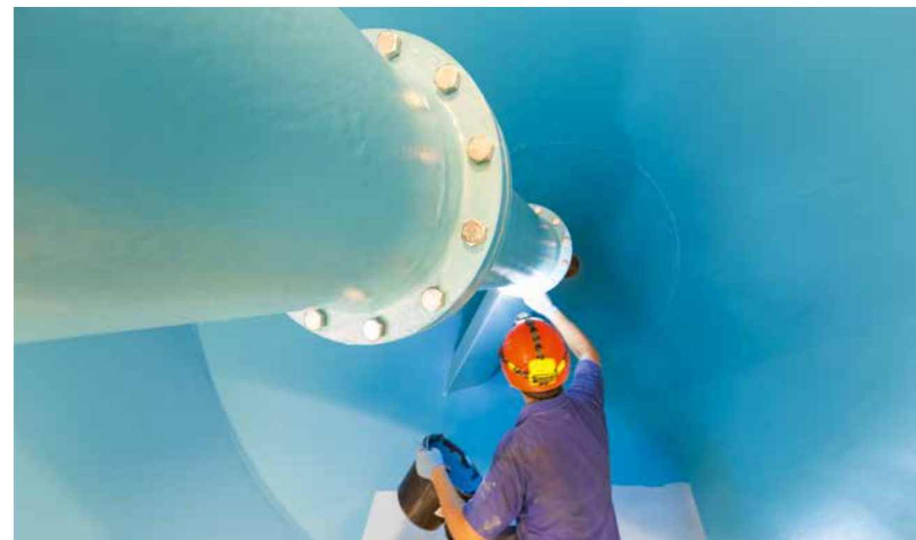
Optionally, the inside of the filter vessel can be provided with an acid-resistant coating. En option, l'intérieur de la cuve du filtre peut être pourvu d'un revêtement résistant aux acides. Opcionalmente, el interior del recipiente del filtro puede estar provisto de un revestimiento resistente a los ácidos.
